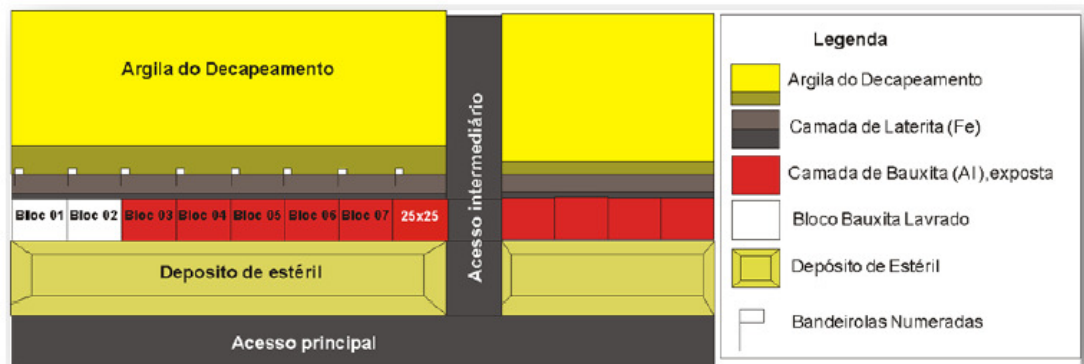
Figura 9 - Funcionamento da lavra strip mining. Fonte: Souza (2014).
