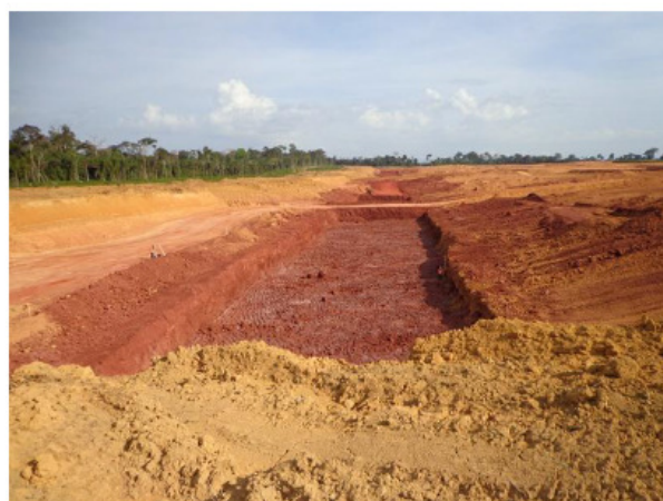
Figura 10 - Tira de bauxita lavrada preparada. Fonte: Brelaz (2013).
