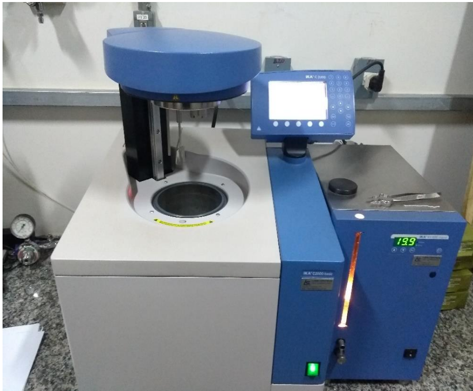
Figura 12 – Equipamento utilizado para determinação de poder calorífico (“C 2000 calorimeter system” - Ika® Werke).
