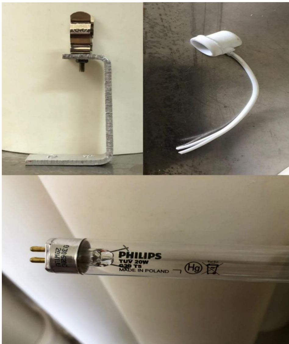
Figura 26 - Componentes do tubo inferior, suporte, soquete e a lâmpada germicida.
