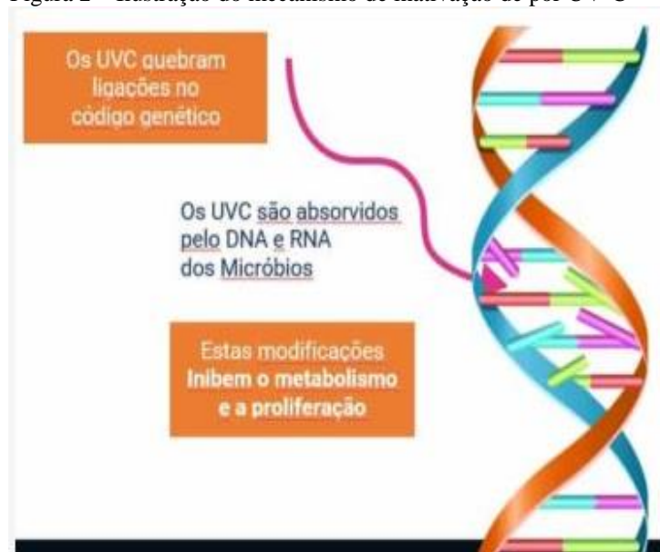
Figura 2 – Ilustração do mecanismo de inativação de por UV-C
