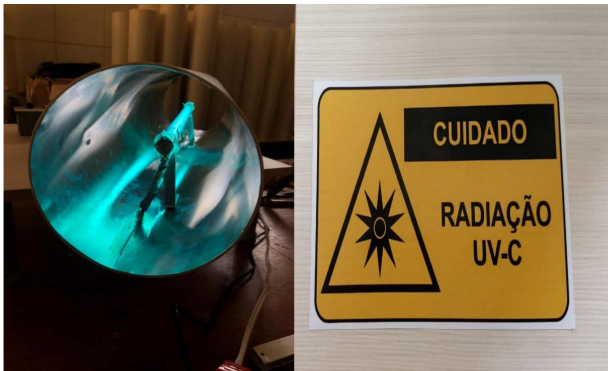
Figura 30 - Lâmpada germicida em teste e o aviso sobre a radiação UV-C
