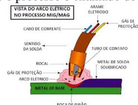
Figura 4 - Vista do processo de solda MIG/MAG através do Arco Elétrico.
