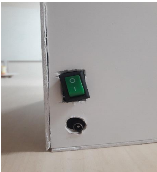
Figura 8(a) – Interruptor e entrada para fonte
