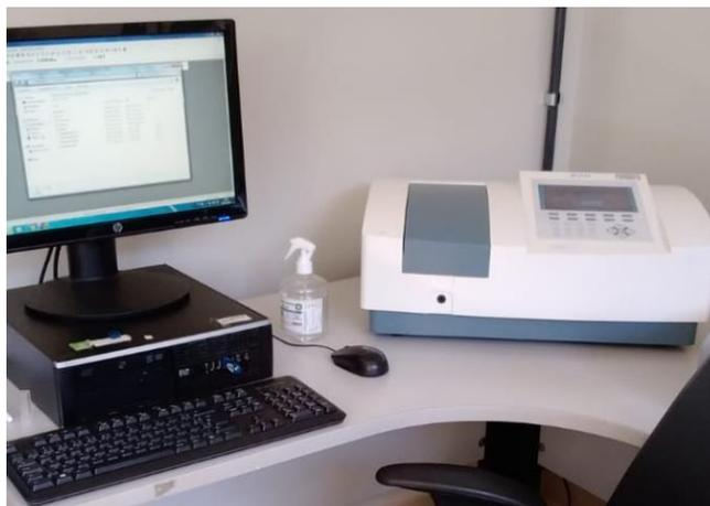
**Figura 7.** Espectrofotômetro Digital de Duplo Feixe UV/VIS. Fonte: Autores/ Central Analítica da Universidade Federal do Oeste do Pará, vinculada ao Órgão Suplementar Rede Integrada de Desenvolvimento Humano (RIDH).
