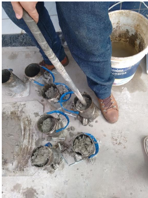
Figura 8 - Vibrações no concreto para exterminação de ar Fonte: Autor
