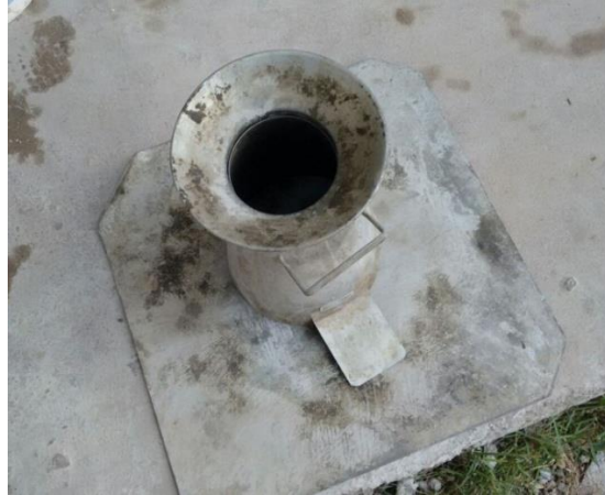
Figura 3 - Equipamentos para o abatimento Fonte: Autor
