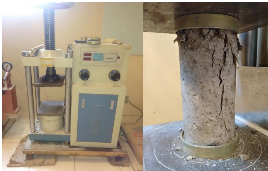
Figura 10 – Prensa utilizada no ensaio de compressão e corpo de prova no momento do ensaio Fonte: Autor
