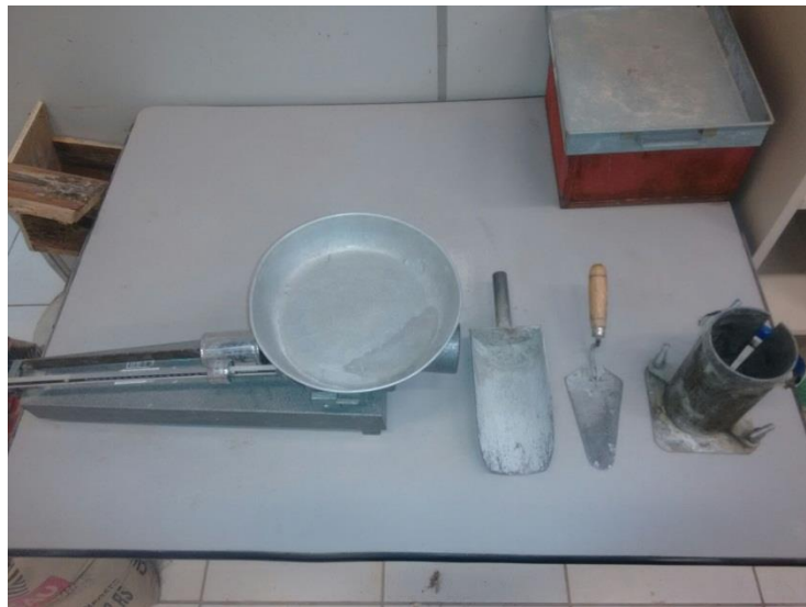
Figura 2 – Balança, Concha metálica, Colher de pedreiro e Molde cilíndrico 10x20cm Fonte: Autor
