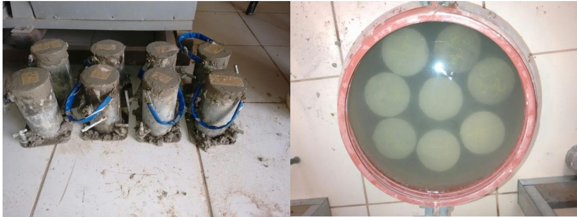
Figura 9 – Corpos de prova devidamente identificados e já em contato com água para sua cura. Fonte: Autor
