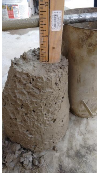
Figura 7 – Ensaio de abatimento do concreto Fonte: Autor
