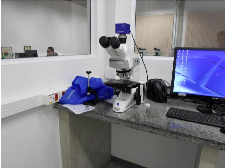
Figura 21 – Microscópio óptico ZEISS AXIO com câmera embutida AXIO CAM ERC55. Fonte: SANTOS, 2015
