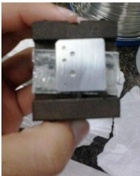
Figura 20 – Amostra de Al 7075 desgastada. Fonte: SANTOS, 2015
