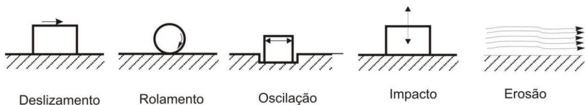
Figura 03 – Classificação dos modos de desgaste. Fonte: CRUZ, 2008
