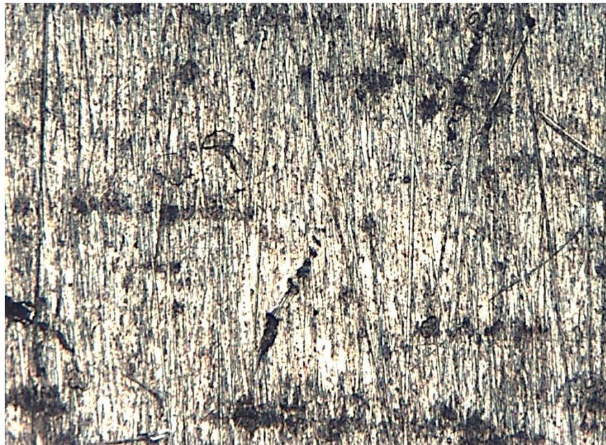
Figura 26 – Metalografia do alumínio: chapa aumentada 500 vezes.
