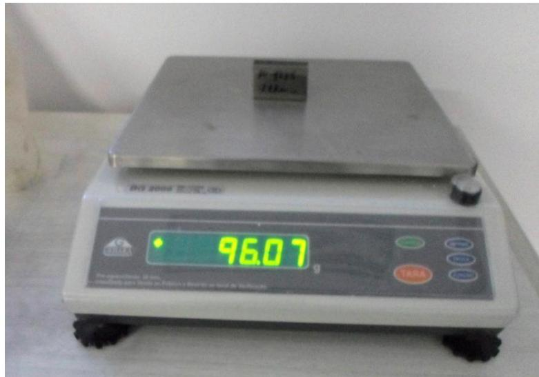
Figura 16 – Aferição da massa de prova em balança analítica. Fonte: SANTOS, 2015.
