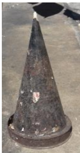
Figuras 12: Molde de Aço para fabrico do Chapéu do Fobó na Forma de Cone, pertencente a Waldir Marinho de Matos Arquivo Paulino/2017
