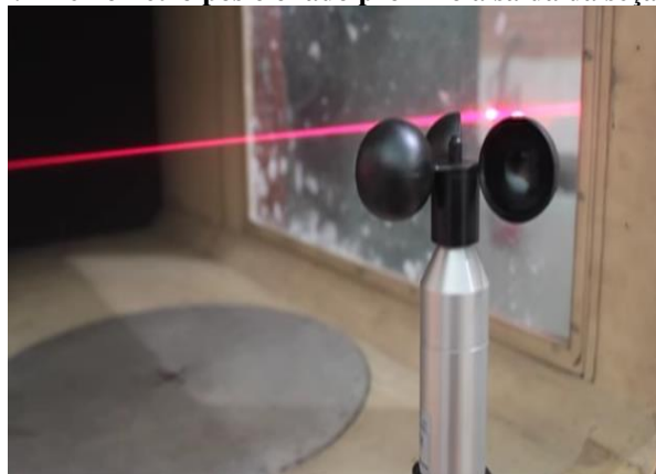
Figura 22: Anemômetro posicionado próximo à saída da seção de testes
