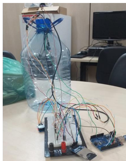
Figura 4. Biodigestor e protoboard montada com os circuitos elétricos.
