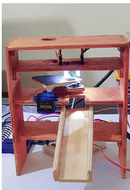
Figura 15 – Protótipo da máquina separadora de peças por cor.
