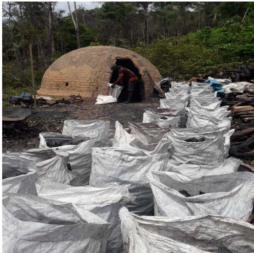
Figura 31 - Processo de ensacamento do carvão em sacas de ráfia em carvoarias tipo rabo quente.
