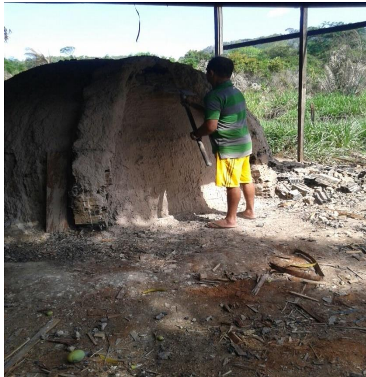
Figura 14 - Trabalhador sem EPI abrindo forno.
