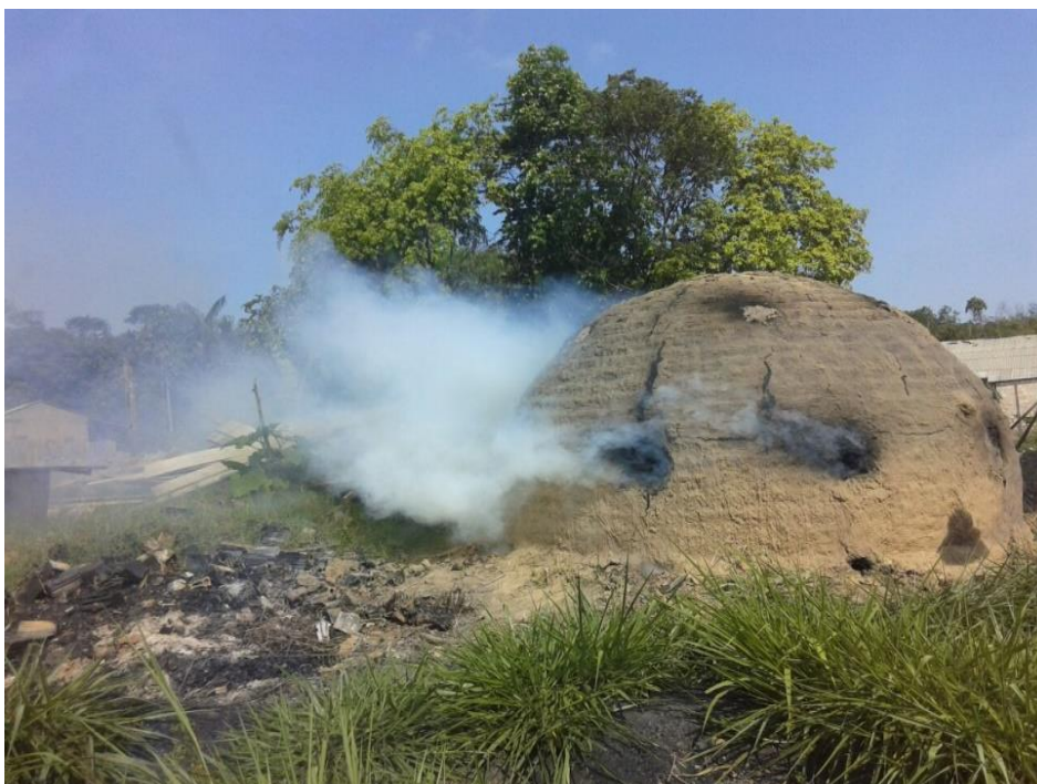
Figura 13 - Processo de queima da madeira em carvoaria tipo rabo quente.
