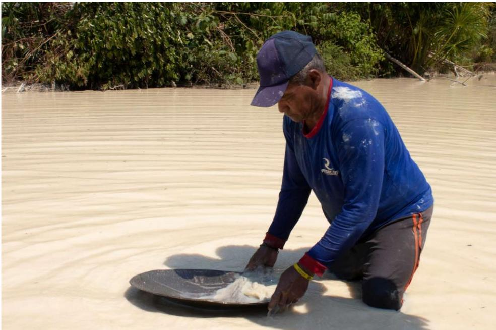
Figura 3-11 Processo de lavagem do ouro.
