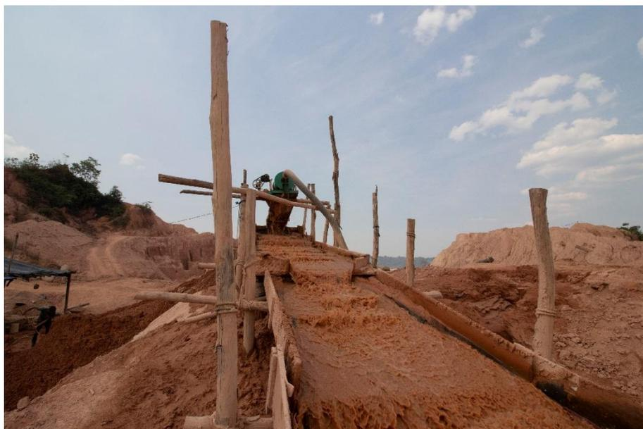
Figura 2-5 Funcionamento da caixa eclusa carpetada.
