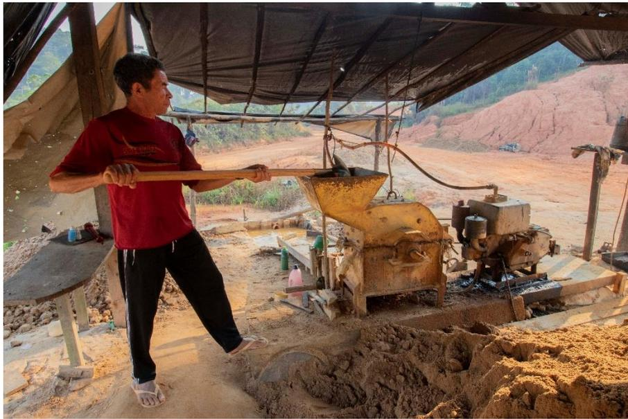
Figura 2-21 Processo de trituração do material retirado do poço no moinho..
