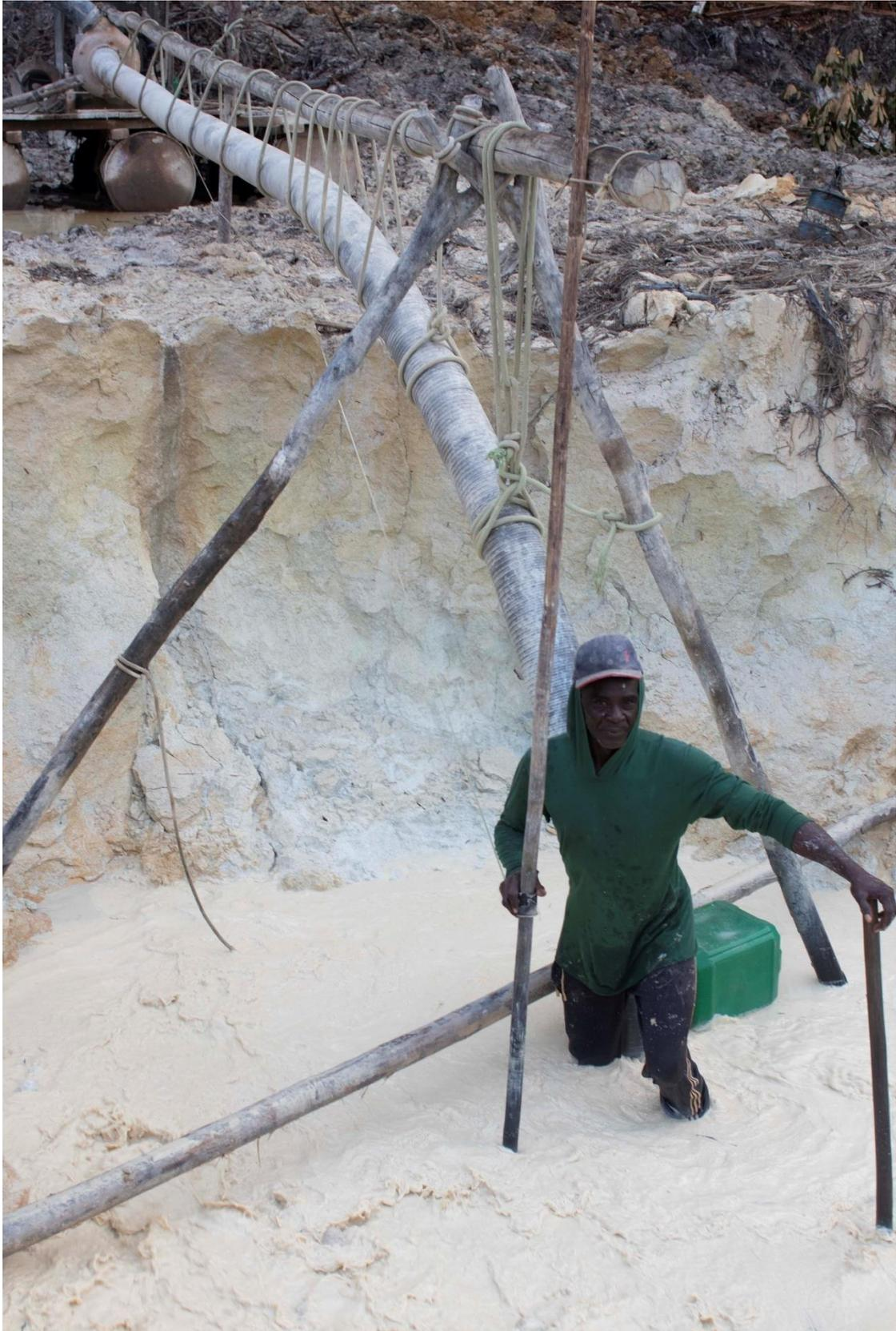
Figura 3-9 Garimpeiro em operação da bomba de sucção com bocal maraca, na área de baixão.
