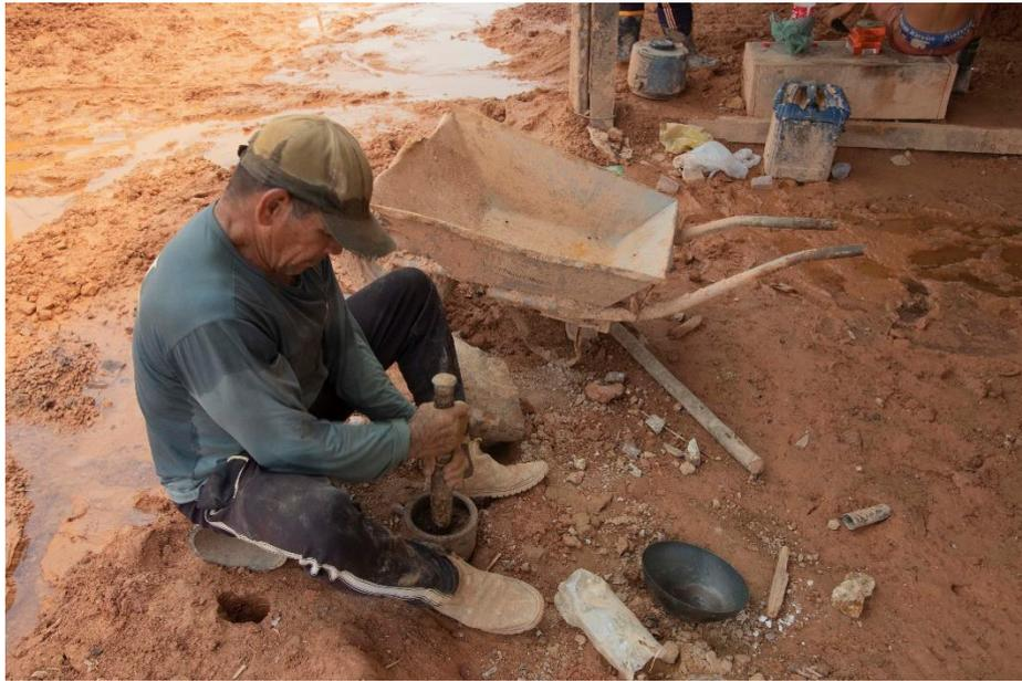
Figura 2-13 Garimpeiro picareteiro triturando manualmente amostra de rocha com ouro.
