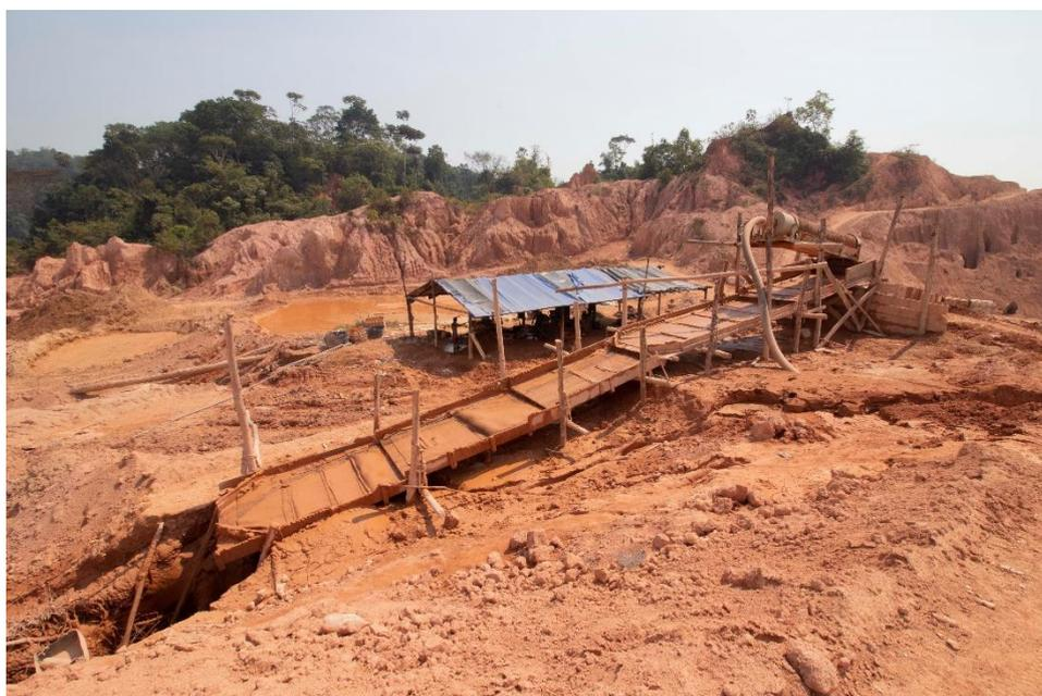
Figura 2-6 Preparação da caixa eclusa carpetada para despescagem.
