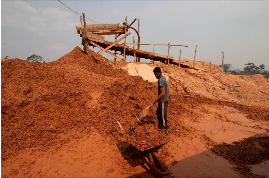
Figura 2-9 As rochas com ouro incrustado são separadas pelo paraquedas e amontoadas próximas à caixa.
