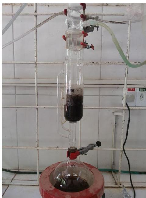
**Figura 7:** Equipamento de extração do tipo “Soxhlet”
