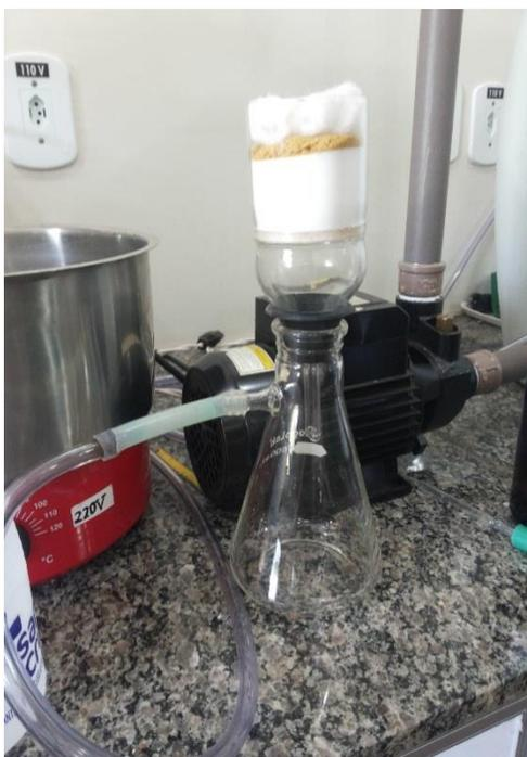
**Figura 9:** Sistema montado para a realização de cromatografia em coluna *flash*.
