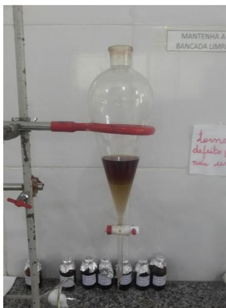
**Figura 8:** Processo de extração do extrato etanólico do resíduo sólido de priproica com ácidos e bases em funil de separação.
