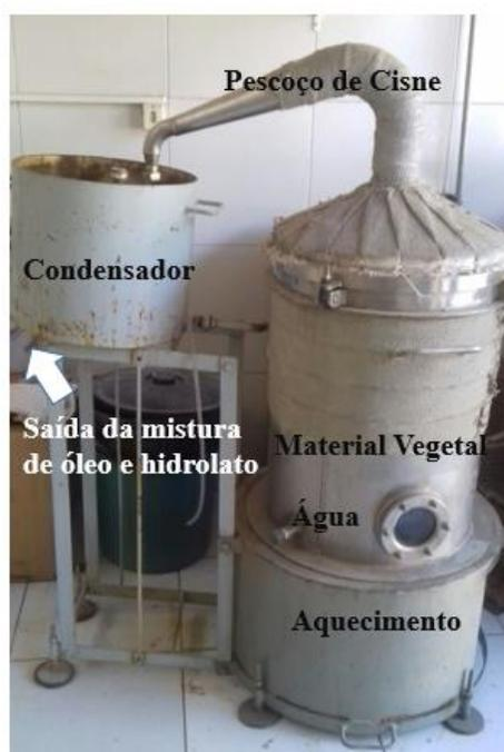
**Figura 6:** Dorna piloto para extração de óleo essencial de material vegetal por arraste a vapor.
