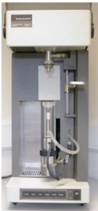
Figura 21. Representação do termoanalisador Natsch que tem um forno cilíndrico vertical (FONTE: GOOGLE IMAGENS).
