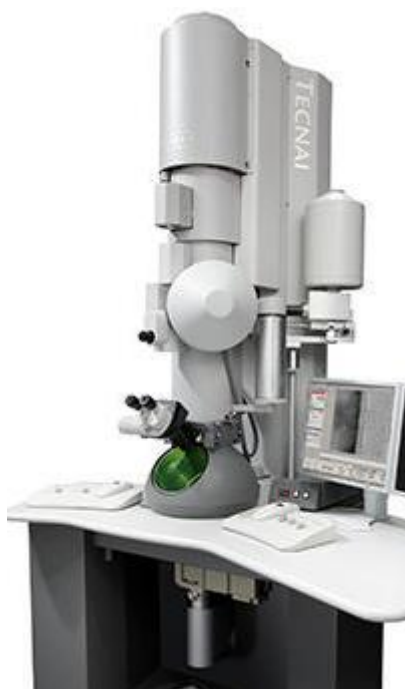
Figura 23. Representação do microscópio eletrônico de transmissão (MET), da marca TECNAI G2-20-FEI (FONTE: SITE TECNAI).
