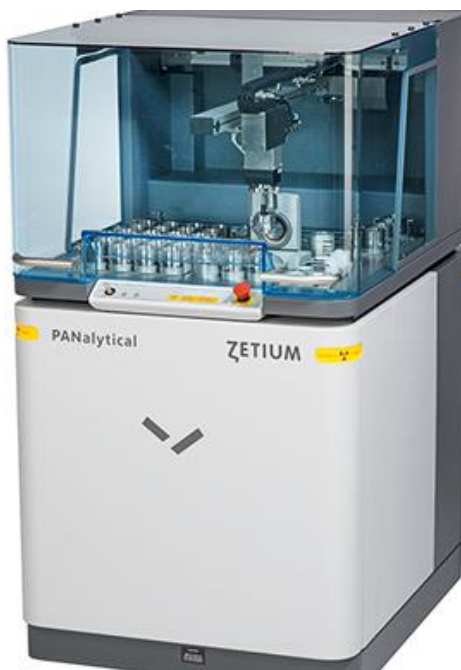
Figura 24. Representação do espectrômetro de Fluorescência de raios-X Sequencial (Axios Minerals, da Panalytical) (FONTE: SITE PANALYTICAL).
