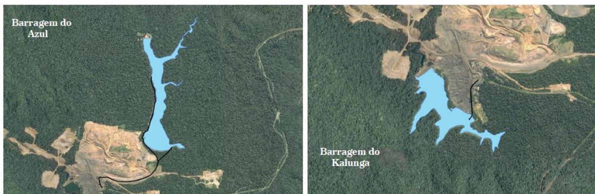
Figura 15. Imagem das barragens do Azul e do Kalunga que retém os rejeitos da mina do Azul (Fonte: ANDRADE e JÚNIOR, 2013).
