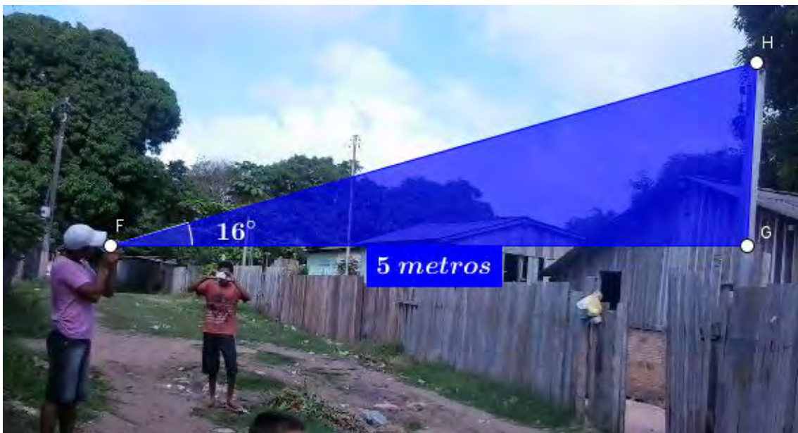
Figura 36: Exemplo de medição de altura usando teodolito
