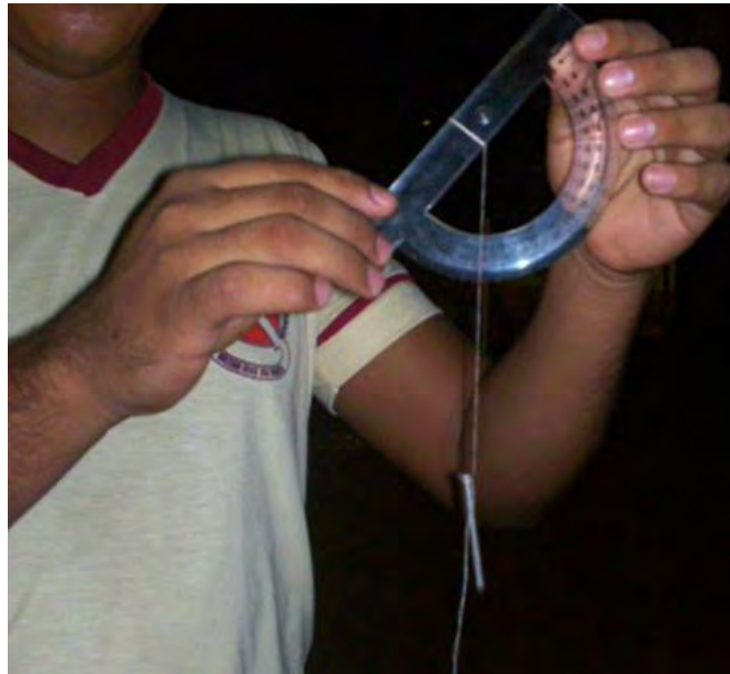
Figura 34: Estudante exibindo o teodolito que construiu
