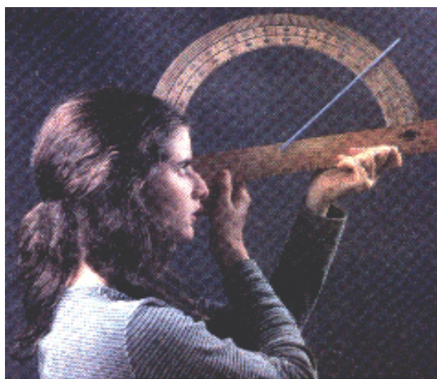
Figura 31: Posicionamento durante o uso do teodolito escolar 14
