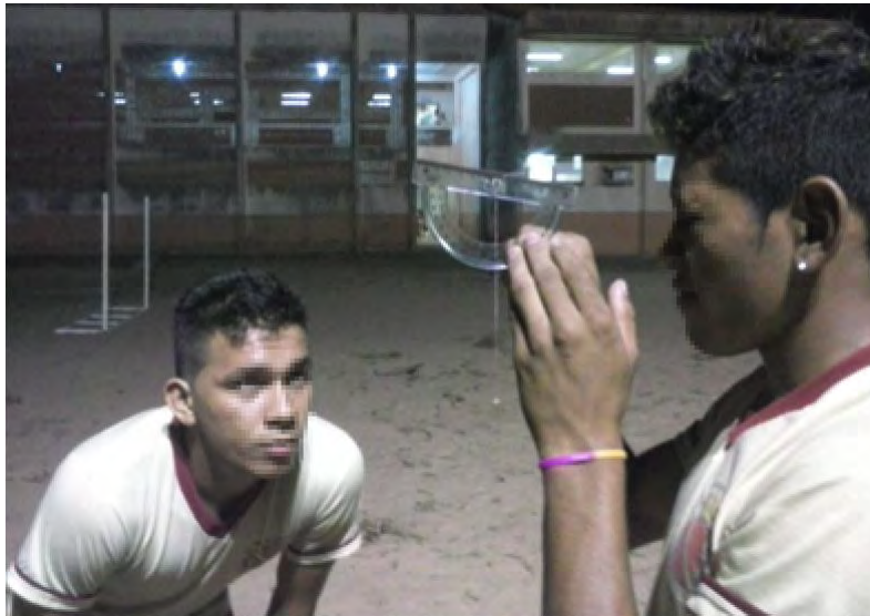
Figura 35: Medição de ângulo vertical usando o teodolito
