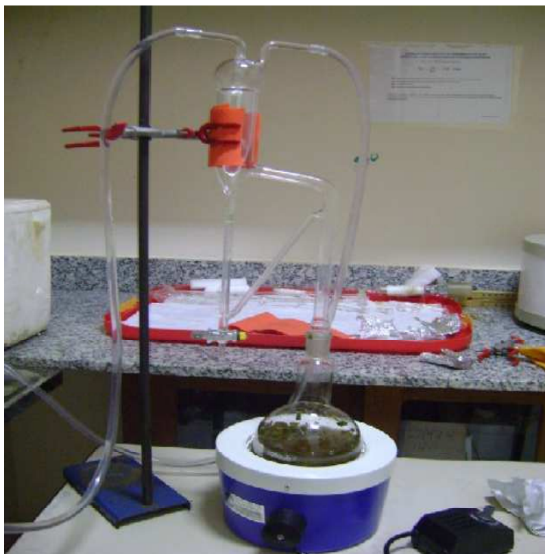
Figura 6: Aparelho de Clevenger
