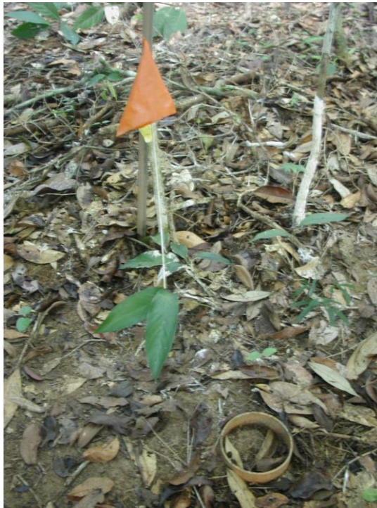
Figura 09 – Anel de PVC utilizado nas leituras de respiração do solo. Fonte: Acervo ESECAFLOR/LBA.
