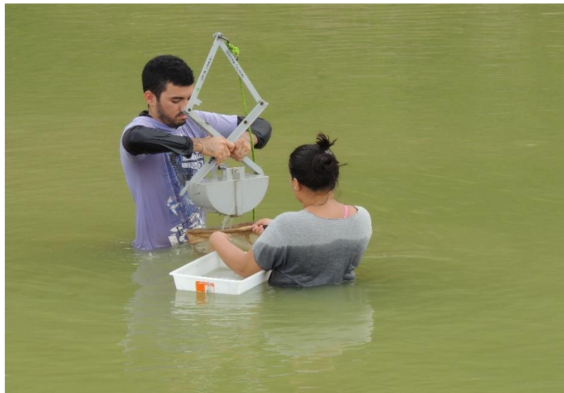
Figura 4: Coleta dos macroinvertebrados de fundo dos viveiros de piscicultura com auxílio de uma draga Petersen.
