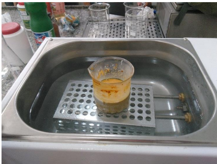
Figura 18 – Procedimento de banho maria no tratamento ácido do rejeito. Fonte: Autoria própria
