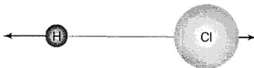
Figura 16 – Os átomos de hidrogênio e cloro se movem para frente e para trás, alternadamente. O movimento do hidrogênio é muito maior que o cloro, porque H tem massa muito menor que Cl.
