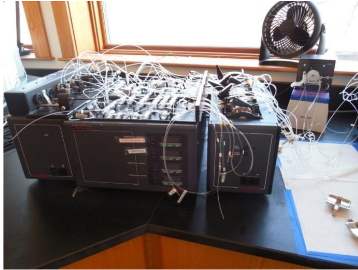
Figura 9: Analisador Astoria com Fluxo de Ar-segmentado e leitura espectrofotométrica. Fonte: Arquivo pessoal.
