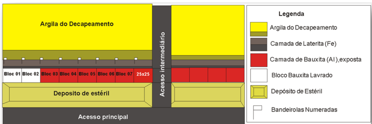
Figura 02: Esquema da lavra strip mining . Fonte: Souza, 2014.
