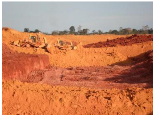
Figura 08: Decapeamento com TE D11 Fonte: AMARAL, 2015.
