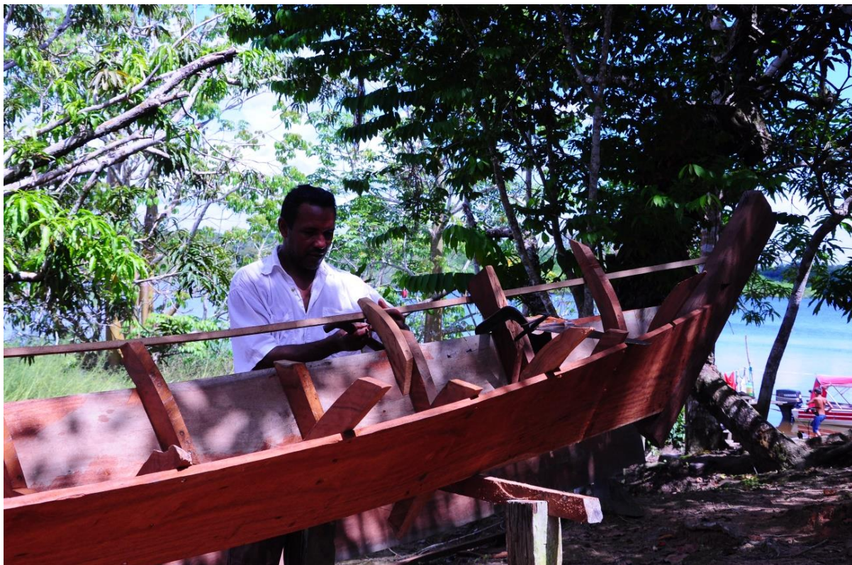
FIGURA 59 – Manoel Raimundo, morador do lago do Acari, constrói embarcação em itaúba. Foto: Ítala Nepomuceno, jul. 2015.
