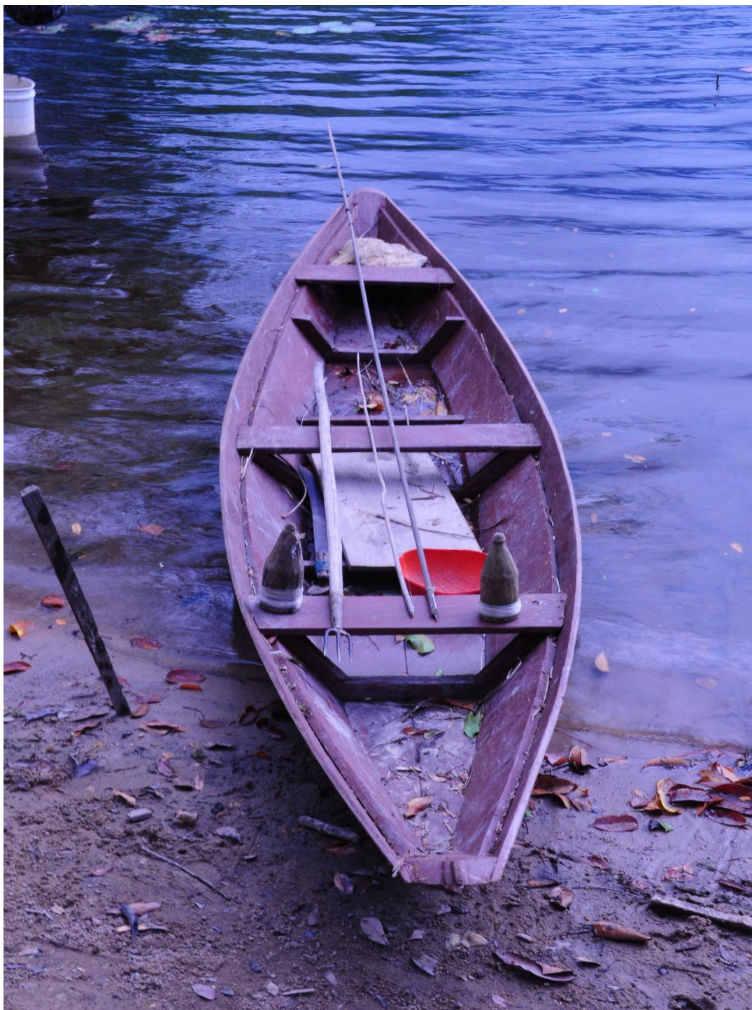
FIGURA 49 – Muitos comunitários fabricam artesanalmente suas embarcações. Por exemplo, a canoa na foto foi construída por seu próprio dono com uma madeira chamada itaúba, e teve suas frestas vedadas com uma resina natural chamada breu. Nos instrumentos de pesca, temos a vara de pesca feita do caule de uma planta chamada cuinha (ou flechal), a zagaia (vara mais grossa) de enviras e as duas “boias” de madeira onde eles amarram as linhas (na frente da canoa) são chamadas de boiete e construídas com um tipo de madeira leve. Foto: Ítala Nepomuceno, jul. 2015.
