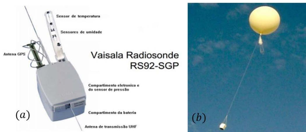
**Figura 3** - Sistema de radiossonda (a) sensores de temperatura, pressão, umidade, direção e velocidade do vento e antena de transmissão (b) sistema acoplado ao balão. Fonte: DECEA.
