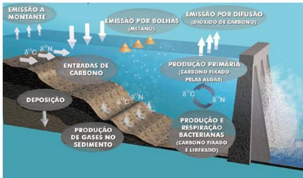
Figura 5: Circulação de  $\text{CO}_2$  e  $\text{CH}_4$  em um esquema de uma represa. Fonte: <https://www.linkedin.com/pulse/gases-de-efeito-estufa-gee-e-usinas-hidroel%C3%A9tricas-do-pessoa>
