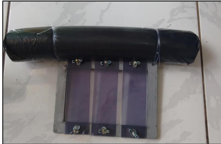
Fotografia 8 - Exemplo de um substrato artificial (amostrador com as lâminas de acrílico).
