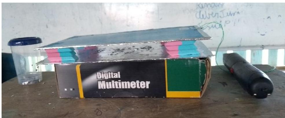
**Imagem 3.1.** Capacitor de Alta Tensão Aplicado no SOME. Fonte: *os autores*.
