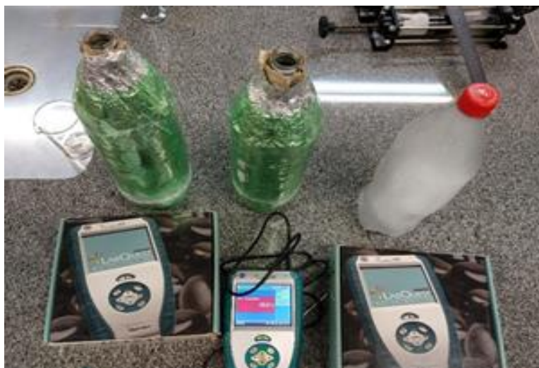
Figura 12 - Medição da temperatura dos líquidos nas garrafas através do LabQuest
