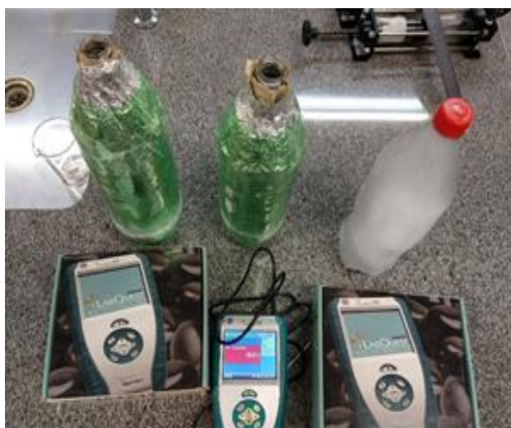
Figura 5 - Medição da temperatura dos líquidos nas garrafas através do LabQuest
