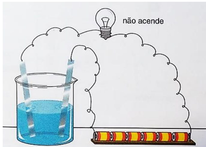
Figura 4 - Eletrodo com água da torneira
