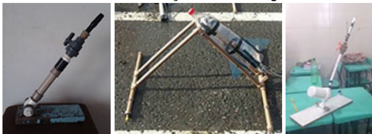
FIGURA 7 – Bases de lançamento dos foguetes utilizadas em outras escolas no passado
