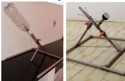
FIGURA 10 – Alguns modelos bases de lançamento dos foguetes construídos na oficina
