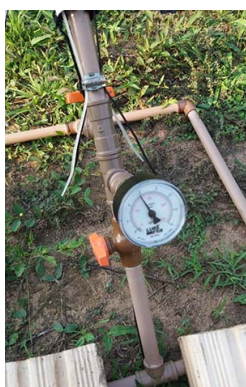
Figura 8 – Manômetro em uso durante um lançamento
