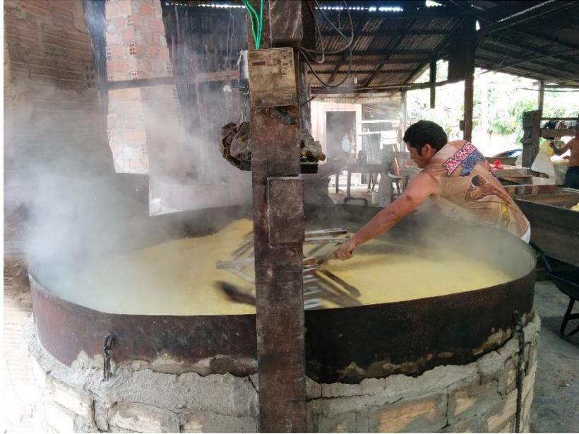
**Figura 38 - Processo de torrefação da farinha amarela**
