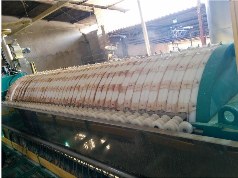
**Figura 45 - Filtro prensa pneumático**
