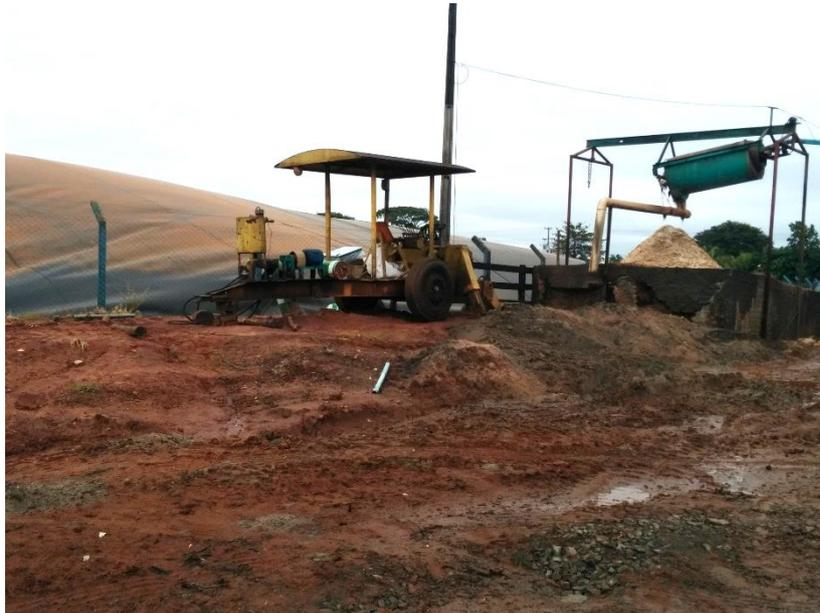
**Figura 44. Separador mecânico de casquinha e água residual de lavagem das raízes**
