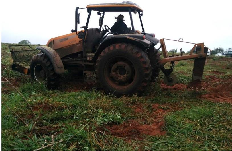
**Figura 41 - Roçadeira e afofador acoplados ao trator**
