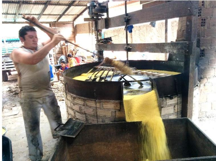
**Figura 39 - Retirada da farinha amarela do processo de torrefação**
