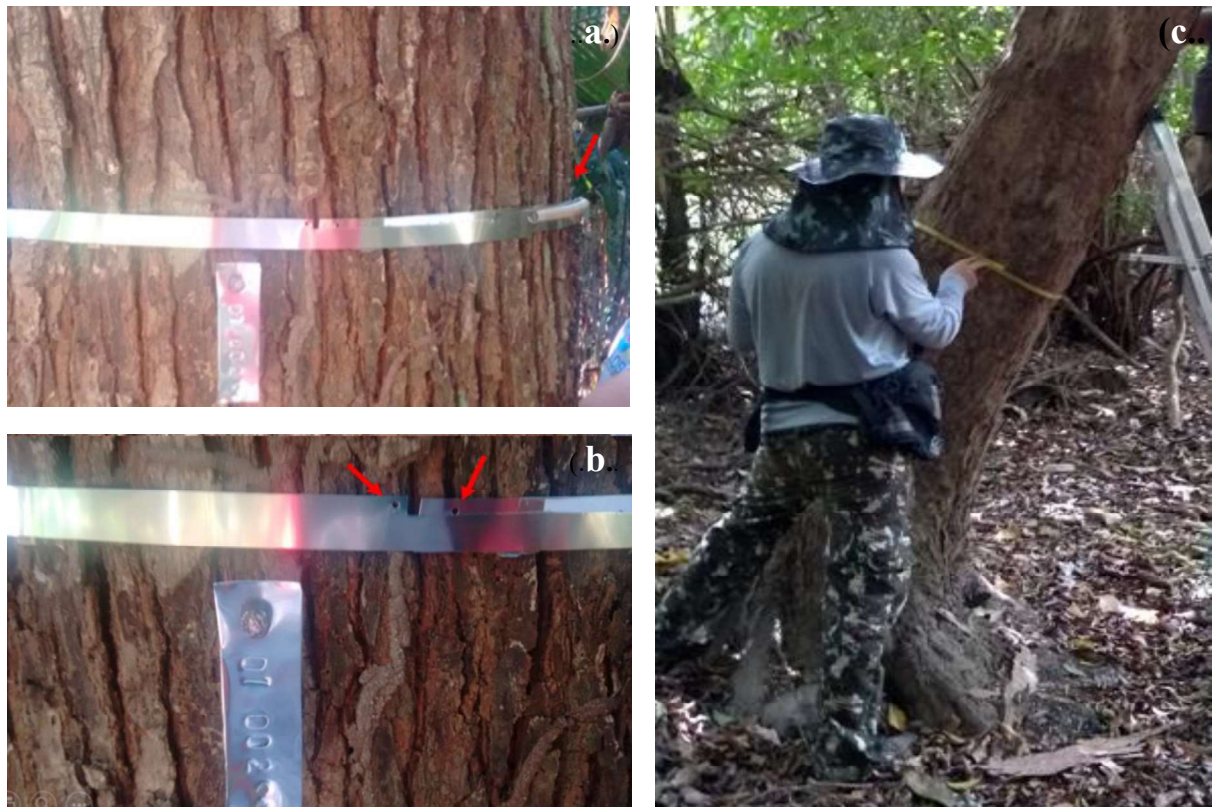
Figura 3: Modelo das bandas dendrométricas (à esquerda), com destaque (setas) para as molas que fazem a fixação das bandas (a) e os furos onde são realizadas as medidas com o paquímetro digital (b); à direita, representa a altura onde estão instaladas as bandas dendrométricas (c).
