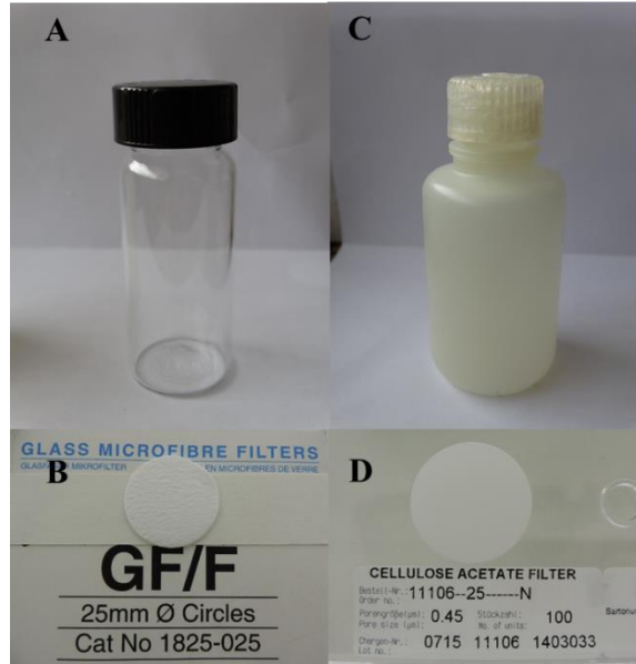
Figura 7 — (A) frascos de boro-silicato; (B) membrana de fibra de vidro, do tipo Whatmann, GF/F, porosidade 0,7 \mu\text{m} ; (C) frascos de polietileno de alta densidade; e (D) filtros de acetato de celulose.
