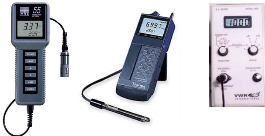
Figura 8 — Medidores portáteis de oxigênio dissolvido, pH, temperatura e condutividade elétrica da água.
