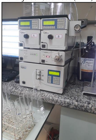
Figura 20 – Cromatógrafo líquido semi-preparativo de gradiente binário, acoplado a um detector de arranjo de fotodiodos (PAD)
