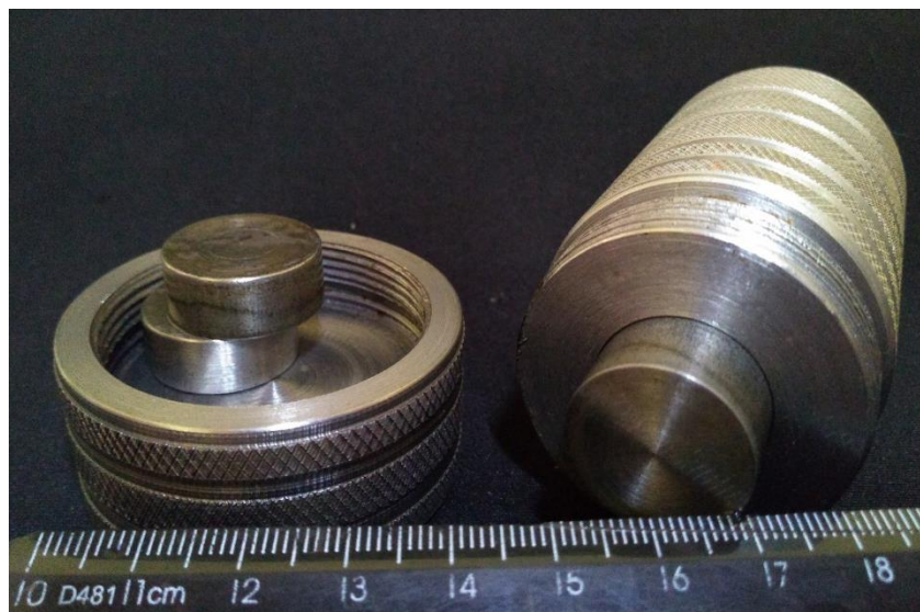
Figura 11 - Peletizadora usada para conformação das amostras
