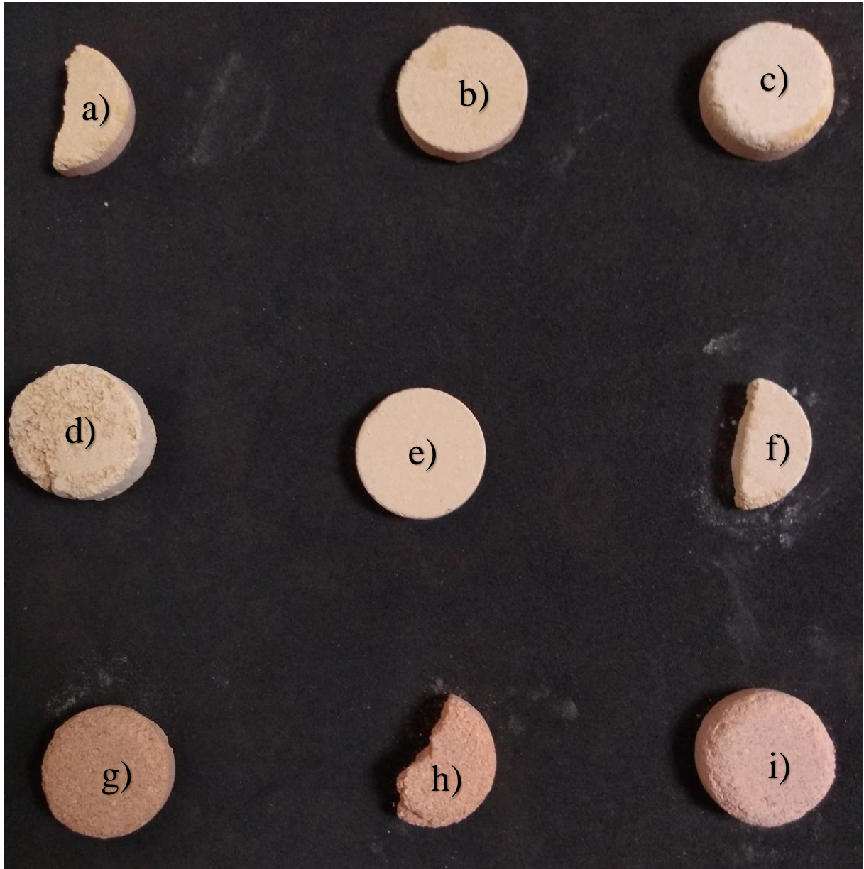
Figura 25– Peças sinterizadas a partir das amostras Zeo_01. a) 500°C b)600°C c)700°C, Zeo_04. d) 500 °C e)600 °C f)700 °C e Zeo_06. g) 500 °C h)600 °C i)700 °C todas por 4h
