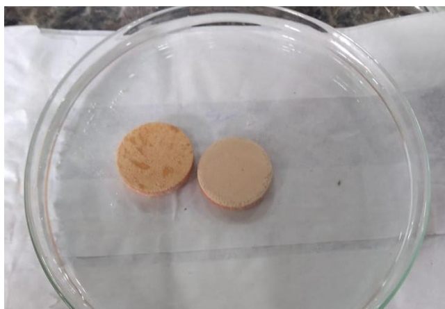
Figura 10 - Teste de imersão (método de Arquimedes)
