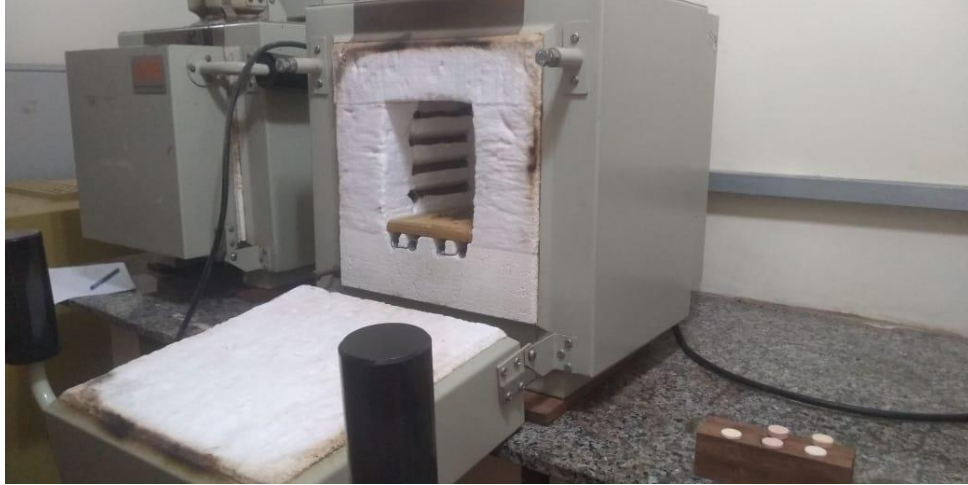
Figura 12 - Forno mufla sendo aberto para retirada das peças cerâmicas
