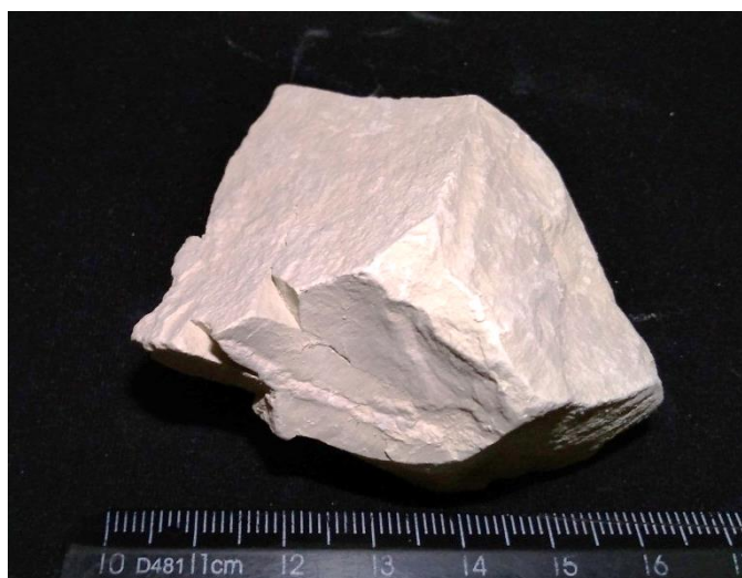
Figura 07 – Amostra de caulim bruto denominado CAU-01 retirado do barranco em Santarém.
