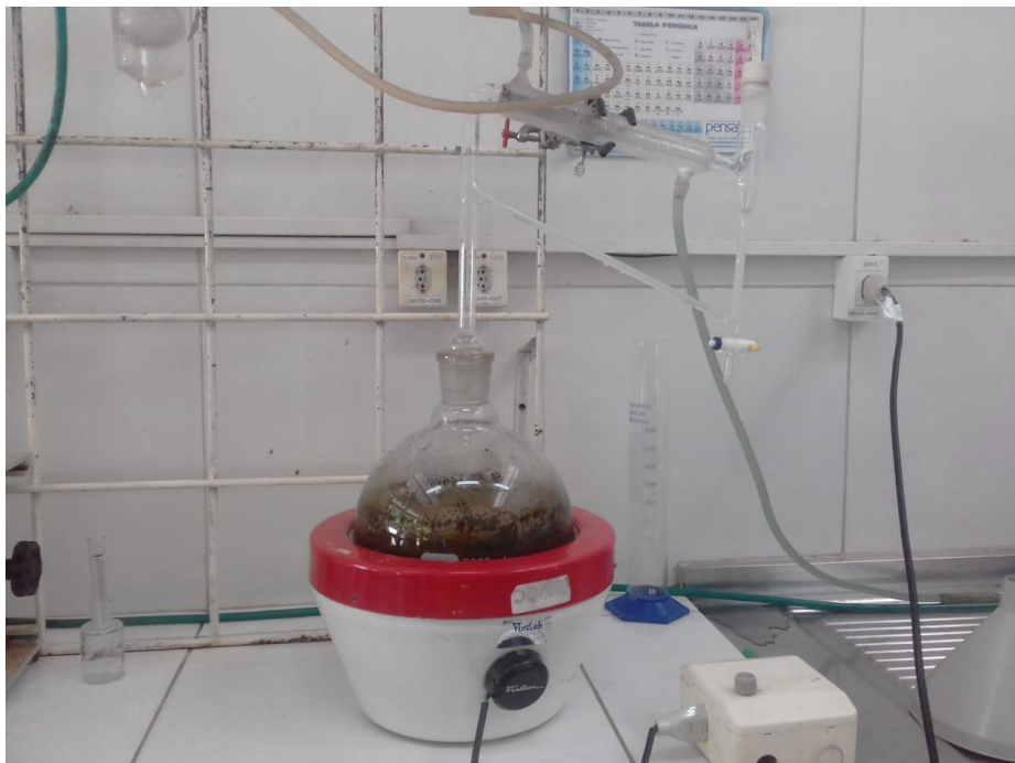
Figura 5 – Extração de óleo essencial de folhas Piper marginatum pelo método de hidrodestilação em aparelho do tipo Clevenger.
