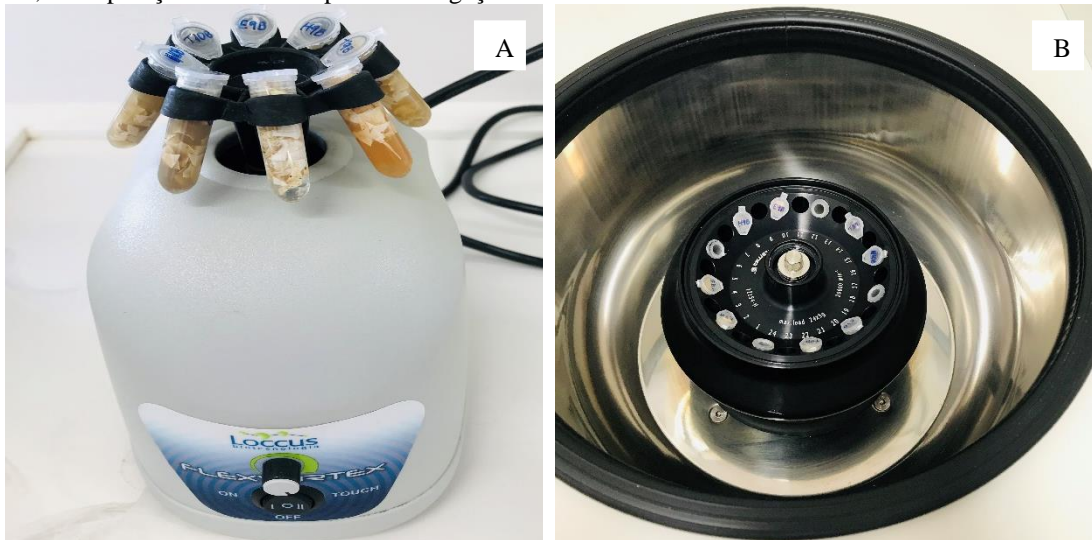
Figura 9 - Processo de eluição viral realizado nas amostras após a concentração viral. A: ressuspensão do material; B: Separação do material por centrifugação.
