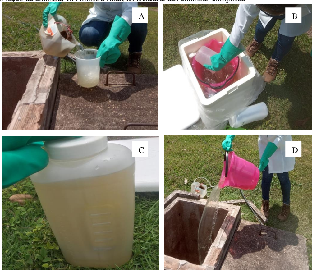
Figura 6 - Procedimento realizado para a coleta de água residuária nos pontos amostrais. A: Amostra composta; B: Conservação da amostra; C: Amostra final; D: Descarte das amostras composta.
