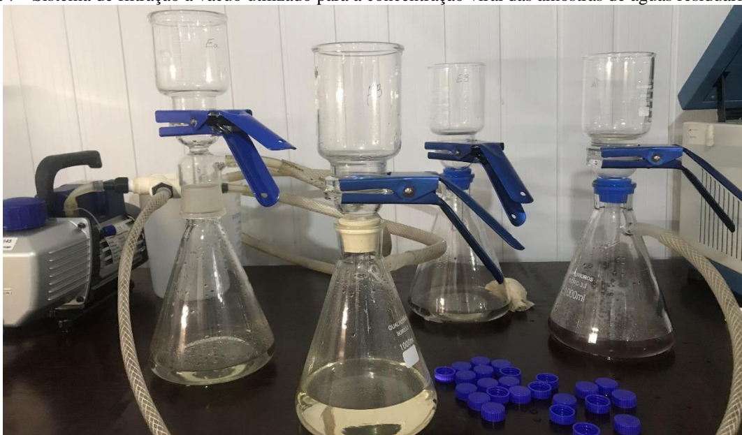
Figura 7 - Sistema de filtração a vácuo utilizado para a concentração viral das amostras de águas residuárias.
